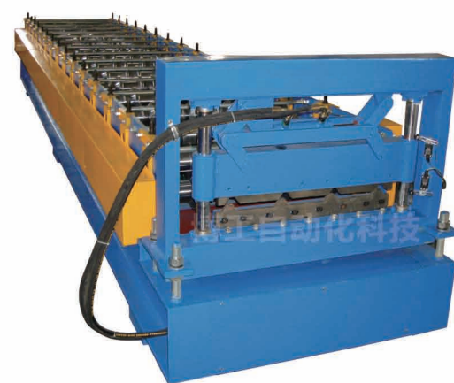
YX25-205-615辊压成型机 YX25-205-615 Roll Forming Machine
